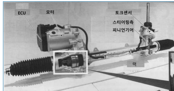
그림 5) 랙방식 EPS(RACK축평행 TYPE)의 구조 스티어링용 피니언부와 랙은 듀얼피니언식과 동일하지만, 모터의 구동은 볼스크류를 사용하는 랙 방식이다. 랙 축과 동축타입에 모터를 배치하는 동축타입에 비해, 사진과 같이 벨트 사용 모터를 랙축과 평행하게 두는 타입은 랙을 슬림화할 수 있기 때문에 범용모터를 이용할 수 있으며, COST적인 면에서도 유리하다. 사진은 Bosch 사의 시스템이다.
